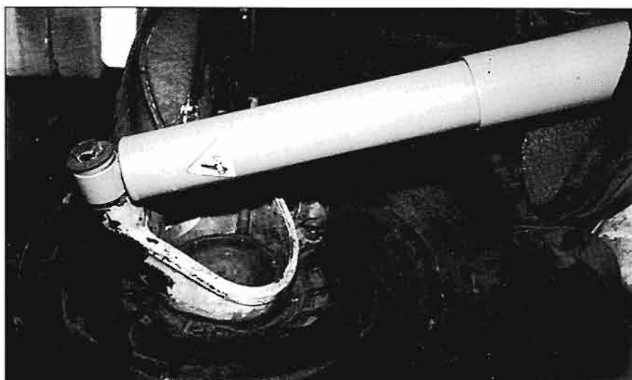
Bildet øverst viser gamle deler som ble til overs; torsjonsstaver, bakre stabilisatorstag og støtdempere. Nederste bilde: Konidempere ferdig montert
