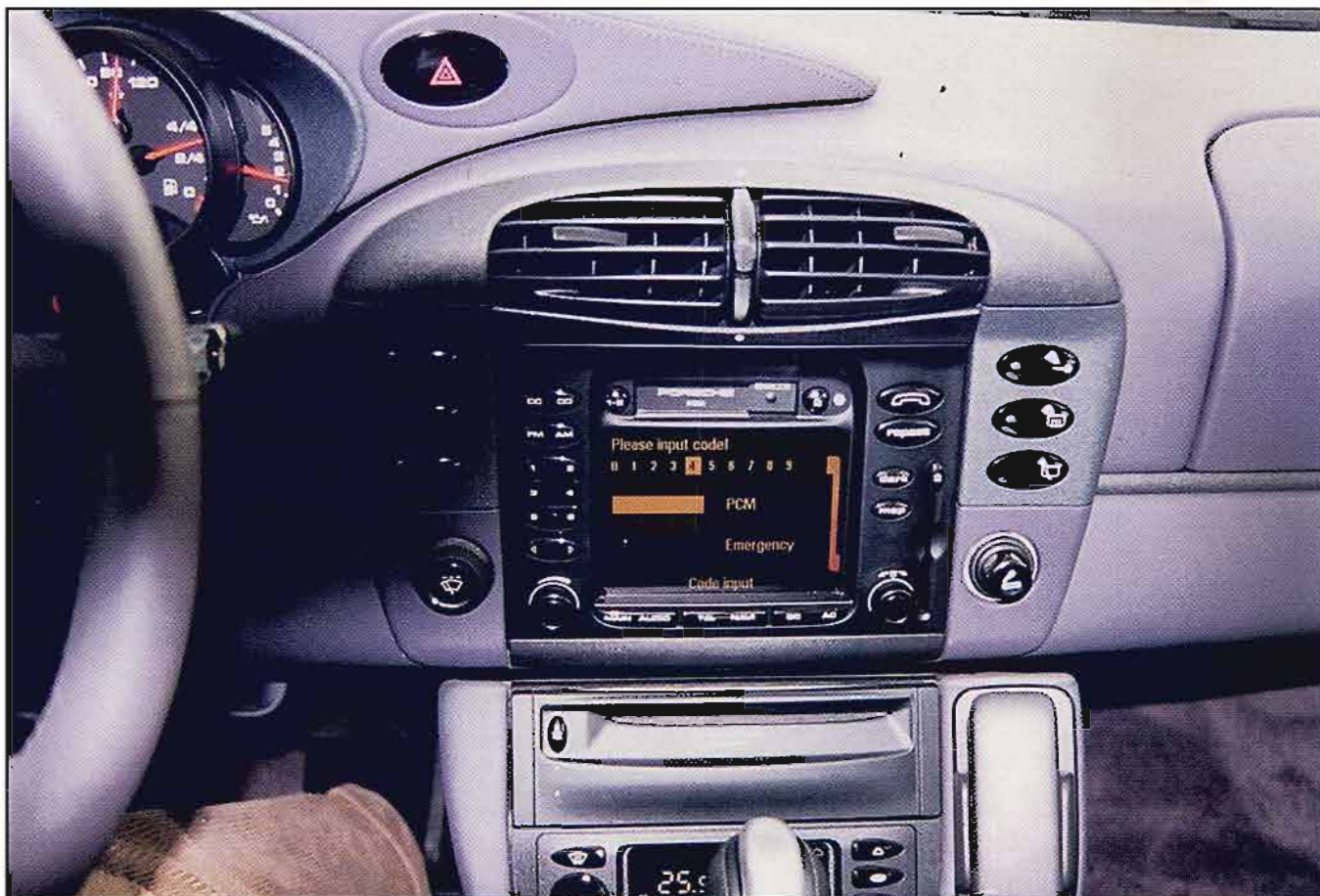
Midtseksjonen i dashbordet inneholder en elektronisk multimedia-enhet. Her finnes musikkanlegg, navigasjonssystem basert på CD-rom og mobiltelefon. Det var bare å putte inn mitt eget PIN-kort og slå koden. Hefstig!
