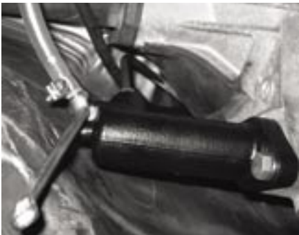
Ny Clutch Slave Cylinder på plass
